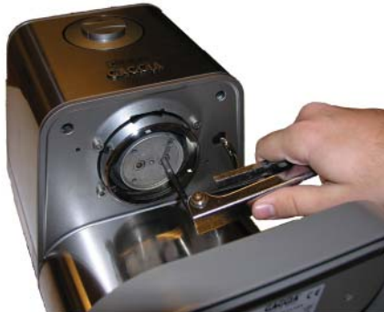
Ta bort och rengör spridarfilterhållaren.
