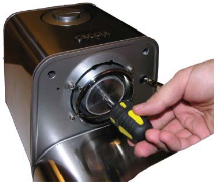
Ta bort spridarfiltret genom att avlägsna krysskruven.
