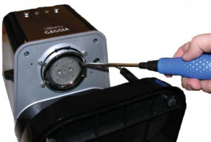
Om spridarfilterhållaren sitter hårt: bänd lätt med en skruvmejsel.
